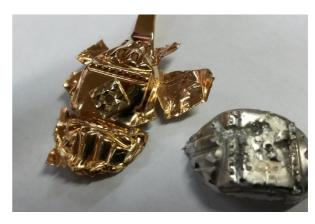
№ 89 **Цепь**, общий вес 46,7, проба 585 и именник фальшивые, довольно толстое напыление, но пропилить можно.
